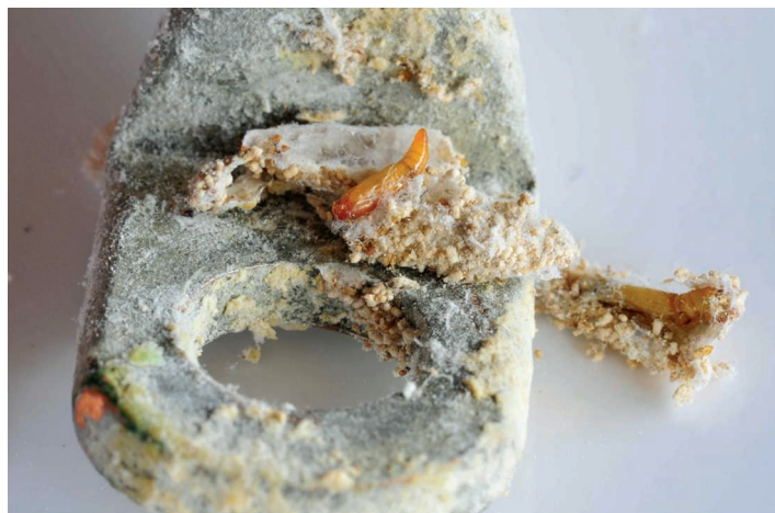
Abb. 3: Mottenlarven an Maschinenteilen
